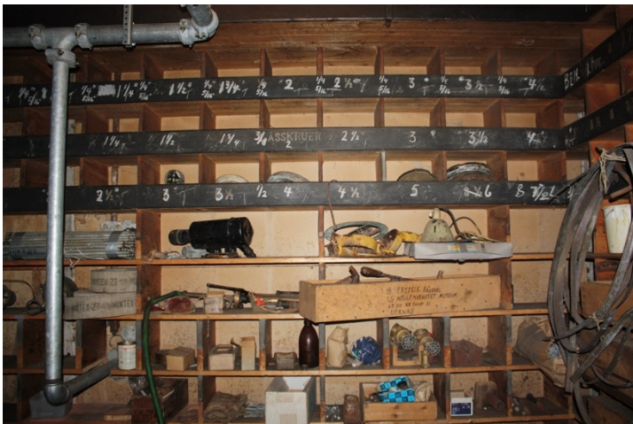
FIGUR 101 MASKINVERKSTED RO 2.5. SKRUELAGER ROM 2.8 VEGGFASTE HYLLER MED DIMENSJONER MERKET I FREMKANT. ALLE HYLLENE HADDE SLIK MERKING, NOEN FJERNET ETTER 1984.
