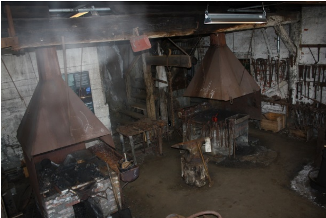
FIGUR 82 ROM 1.1 SMIE. LANGESSA T.V. OG VANLIG ESSE T.H. BAKVEGG DELVIS AV BETONG, DELVIS AV BERG. JORDGOLV.
