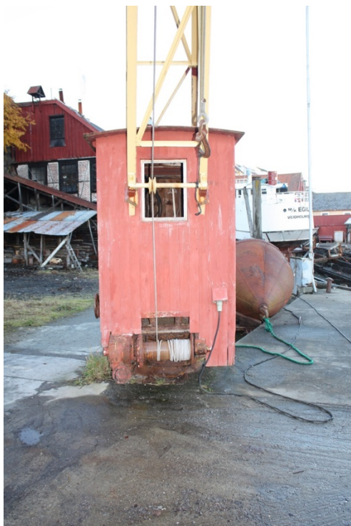
FIGUR 138 UTEAREAL NR. 16 KRAN. SETT MOT N. TROMMEL TIL VINSJWIRE I BUNNEN AV KRANHUSET.
