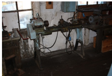
FIGUR 91 MASKINVERKSTED ROM 2.5. METALLDREIEBENK MED ELEKTRISK MOTOR. OPPRINNELIG DREVET MED FOTTRØE, TROLIG EN DEL AV DEN OPPRINNELIGE MASKINPARKEN.7
