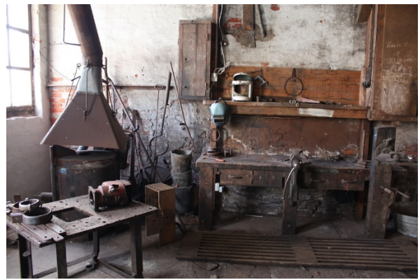
FIGUR 84 BYGNINGNR. 2 VERKSTEDBYGGET. ROM 1.2 SØ HJØRNET. AVTREKKSØR AV SKORSTEIN FRA DAMPSKIP. SMELTEOVN.
