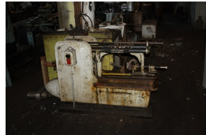
FIGUR 89 MASKINVERKSTED ROM 2.5. KALDSAG TIL SKJÆRING AV STORE METALLENGDER, BYGD PÅ MELLEMVÆRFETET.
