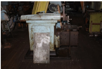
FIGUR 90 MASKINVERKSTED ROM 2.5. SHAPINGMASKIN, DREVET AV SENTRAL REIMDRIFT.
