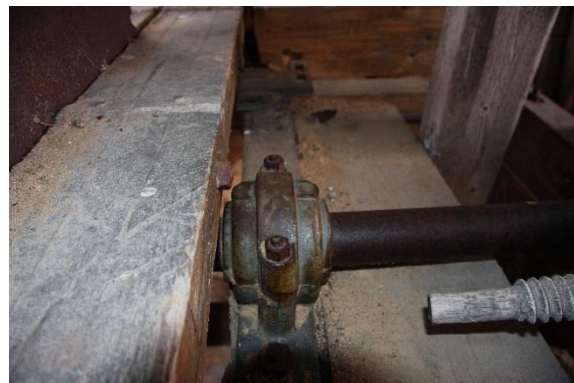
Figur 45. Sagspindel, med sagblad til venstre og drivhjul til høyre (utefor bildet).
