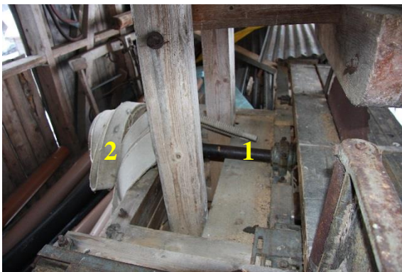
Figur 44. Sagspindel (1) med drivhjul og reim (2). Reimen ligger kveilet rundt drivhjulet.
