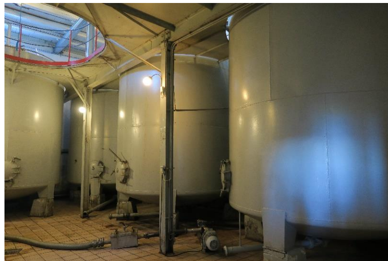
Gjærkarene blir fylt fra toppen med en flyttbar slange, større løst inventar. Kar sett fra sørvest.
