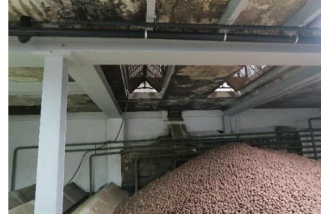
Tv. fra vektene i 2. et. slippes potetene ned i kjelleren for å vaskes. Th. plantegning over potetkjelleren.
