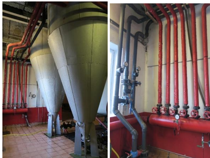
Tv. potetkokere og th. detalj av dampledere til potetkokerne.
