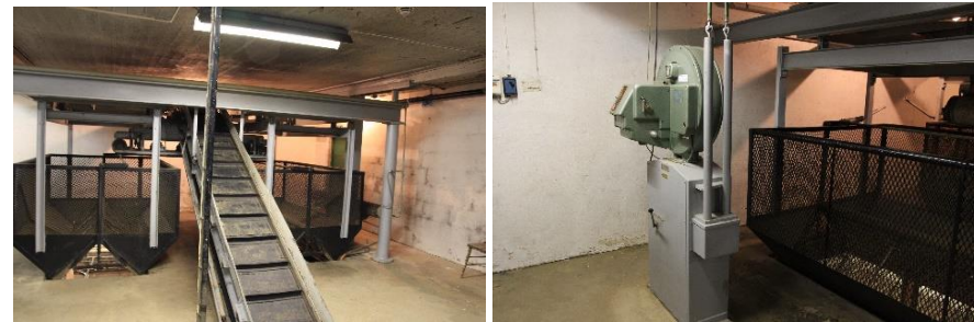
Tv. to kurver for veiing og transportbånd opp til kurvene. Th. vekten med kort der den avleste vekta stemples inn. Foto, begge bildene: Ulf Gustafsson, Riksantikvaren 2015
