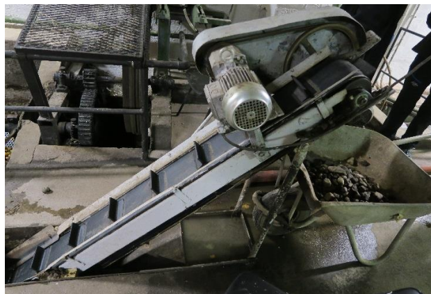
Inn mot potetvaskeren renner poteten over et hull som gir vann i motstrøm. Dette trykket er påført vannet for å gi poteten et løft når den renner forbi hullet. Steiner har så stor egenvekt at de her vil bli skilt ut fra potetene. Steinen faller ned på et transportbånd som fører steinen til ei trillebår (større løst inventar). Steinene trilles ut manuelt.
