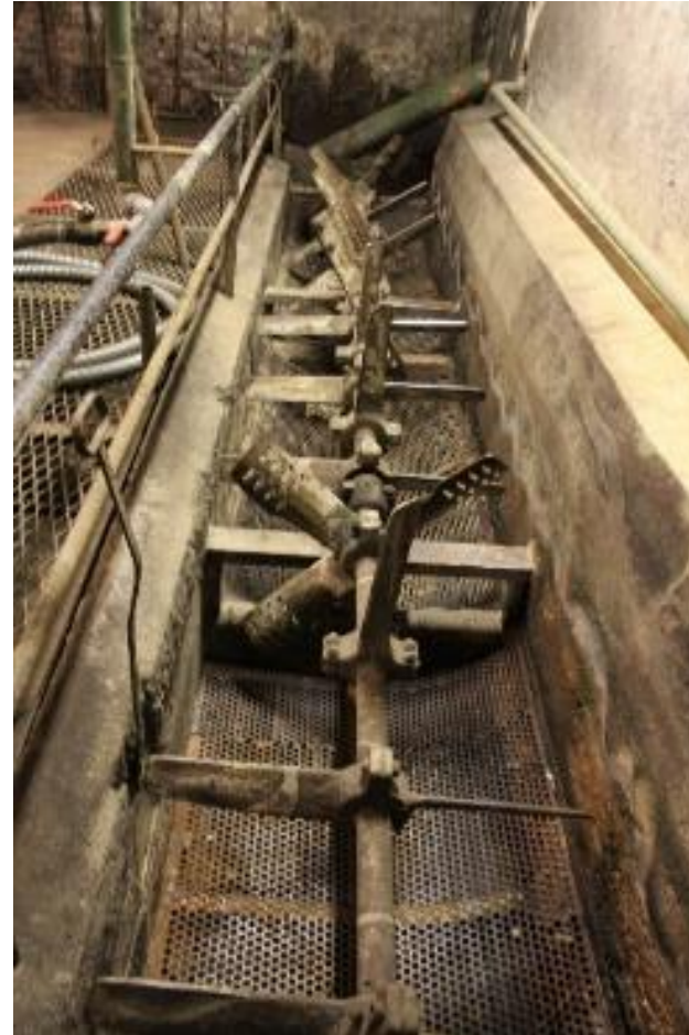
Grønt rør lengst bak i bildet er røret potetene pumpes videre i prosessen. Foto: Ulf Gustafsson, Riksantikvaren 2015
