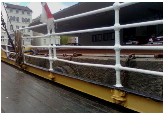
Rekka midtskips kan løftast av slik at bilar kan køyre om bord på framdekket.
