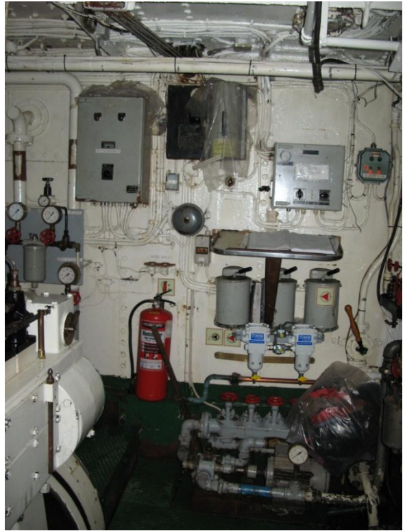
Den originale kullbaksen med skyveluke til sentralfyren atter på babord side av maskina (venstre over). Frontskott på styrbord side av maskina med hylle for maskindagbok (høgre over).
