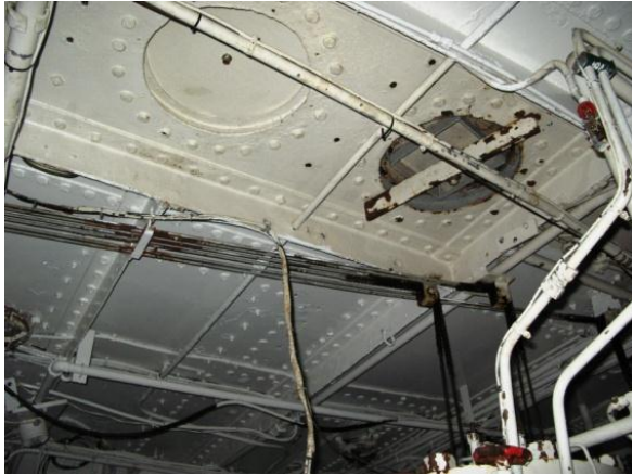
Original opning i dekk for stempeltrekk på den 2-sylindra Bolinder-maskina som "Granvin" vart levert med i 1931 (venstre over). Hovudstraumtavle på frontskott (høgre over).
