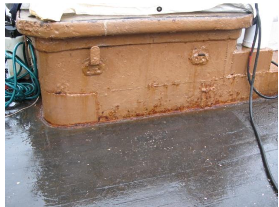
Spor etter tidligere vantfeste på babord svinerygg (venstre) og lasteluke med beslag (høgre).
