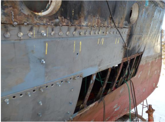
Et omfattende plateskift måtte til for å beholde sertifikatene. Dåfjorden Slip 07.12.2012. Foto Erik Småland, Riksantikvaren.
