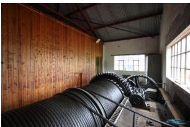
Maskinhus Tinnoset, maskinrom med slippwire og wireluke.
