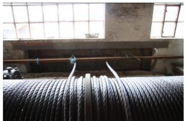
Maskinhus Tinnoset, maskinrom med slippwire og wireluke.
