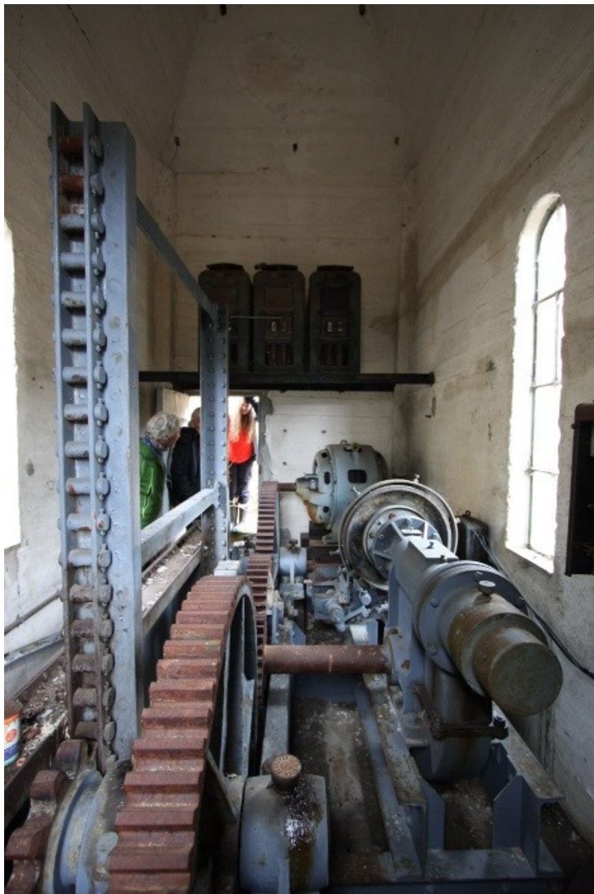
14.1 Drivverksmaskineri. Tre transformatorer på hyllen i gavlen.
