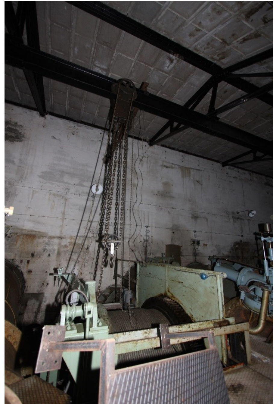
(10.5.) Drivverk for trallebanen med jernbjelke, trinser, kjettinger, drivhjul og øvrige deler.
