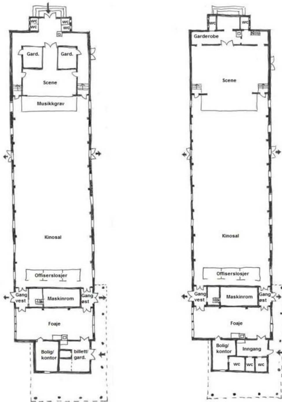
Planskisser av Dombås kino etter tegning av Sigurd Lilleløyken. Skisse til venstre viser planløsning slik den var opprinnelig. Skisse til høyre viser dagens situasjon.
