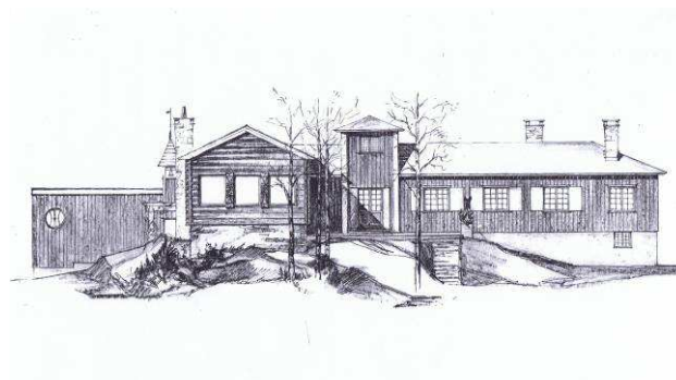
Fra prosjekteringen av nye Herrodd i 1940, tegning av Magnus Poulsson, oppriss mot nordøst av ny garasje med klokketårn, ny laftet storstue og tilbygg mot nordvest (under valmen til høyre på tegningen). Kilde: Poulsson m. fl., 1952.
