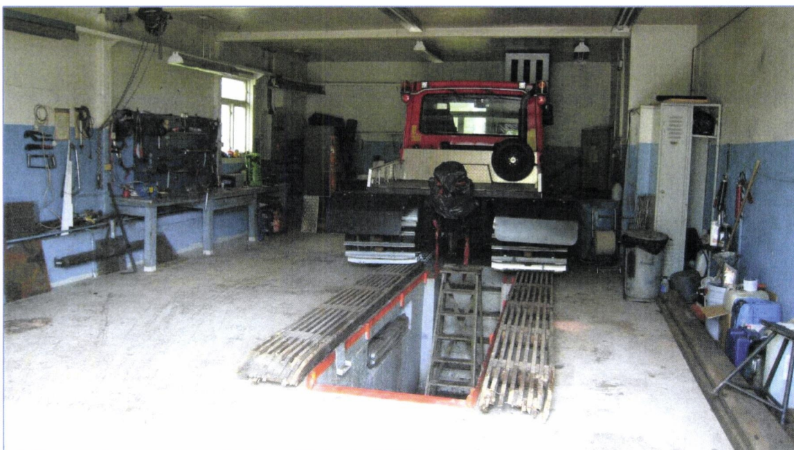
Smøregrav inne i garasjen/verkstedet.
