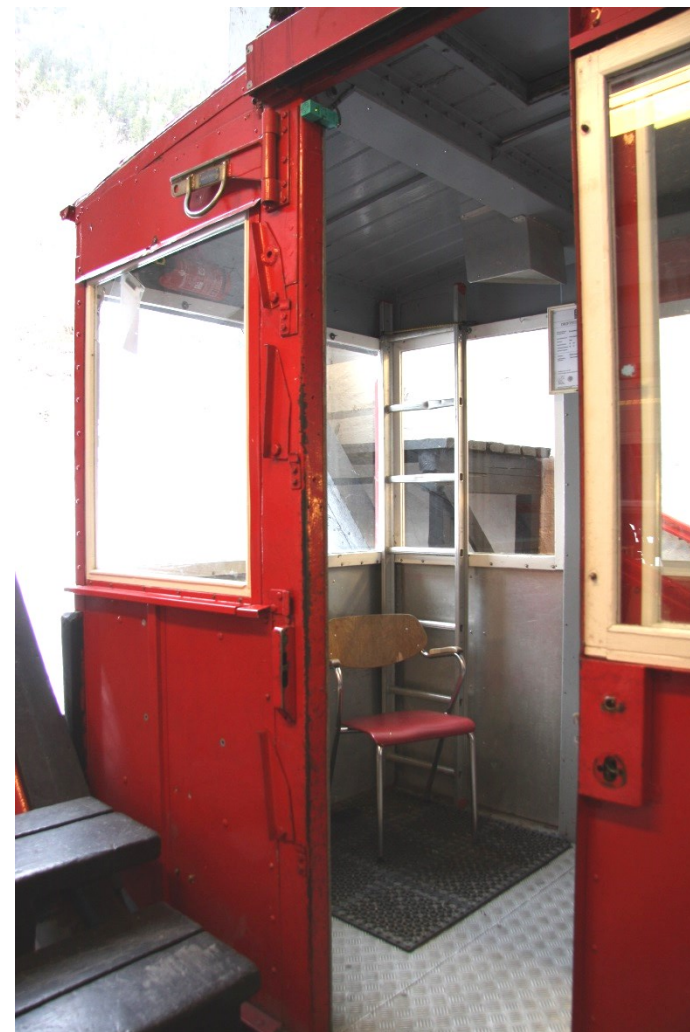
Vogn 1 i dag med tretak og klinket rammeverk. Gulvplatene er nye.
