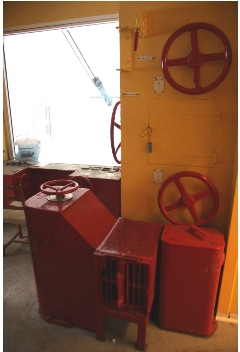
2.3.1 Styringspult fra 1950-årene og 2.3.2 opprinnelig bremsemaskineri og nøddriftshjul i den gamle drifts-sentralen/kontrollrommet.
