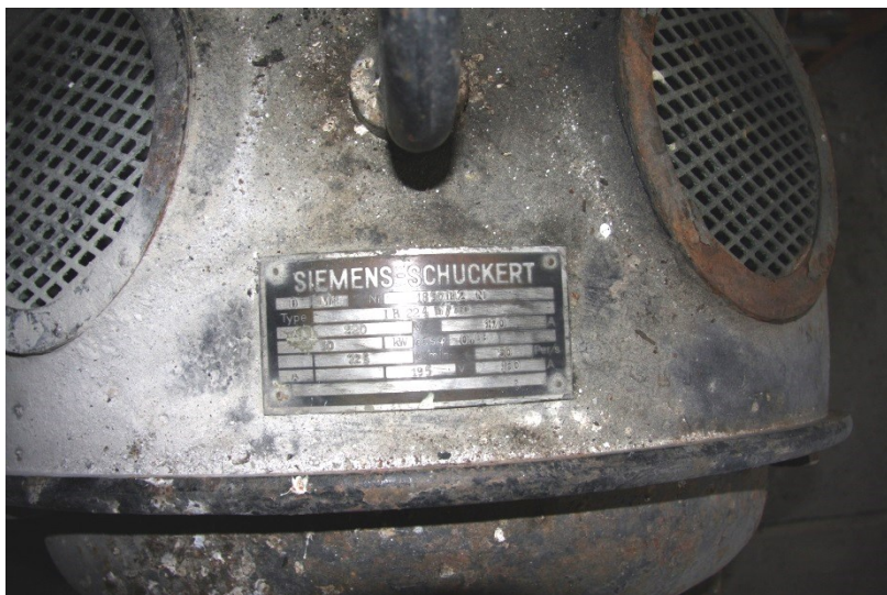
2.1.1 fabrikkmerke på motor fra Siemens.
