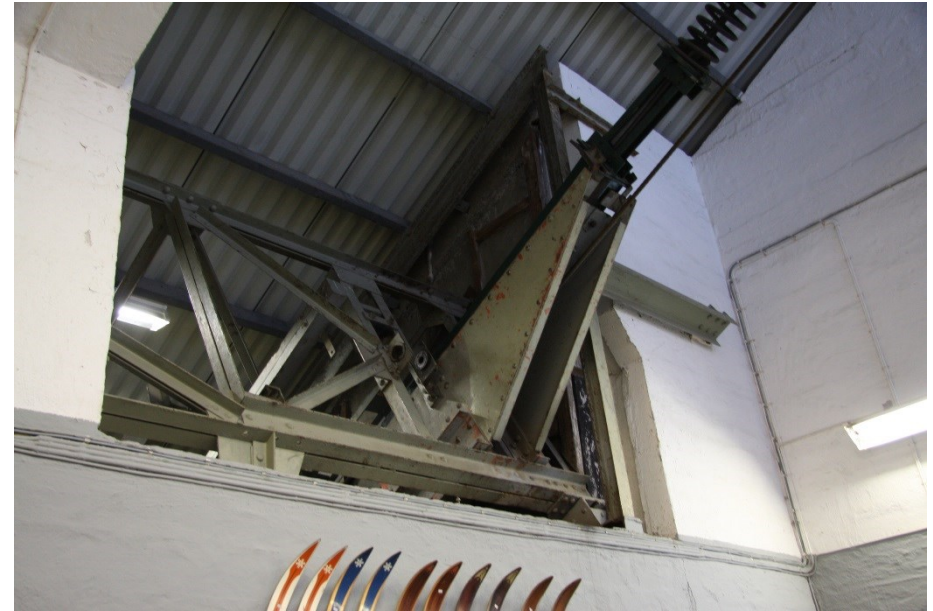
Over: 1.2.1 bærestativ og utgang for 1.2.3 tau og fjær i vest sett fra Vognrommet. Under: Vestre sjakt for 1.2.2 lodd og 1.2.1 drivverk til vogn nr. 2. Over sjaktåpningen i vest er kran for heising og senkning av lodd.
