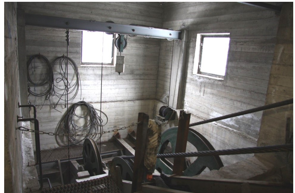
Over: 1.2.1 bærestativ og utgang for 1.2.3 tau og fjær i vest sett fra Vognrommet. Under: Vestre sjakt for 1.2.2 lodd og 1.2.1 drivverk til vogn nr. 2. Over sjaktåpningen i vest er kran for heising og senkning av lodd.
