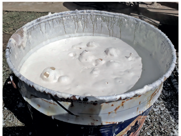
▲ «Koklesking» (våtlesking) av vedbrent kalk til slemming og hvitting
