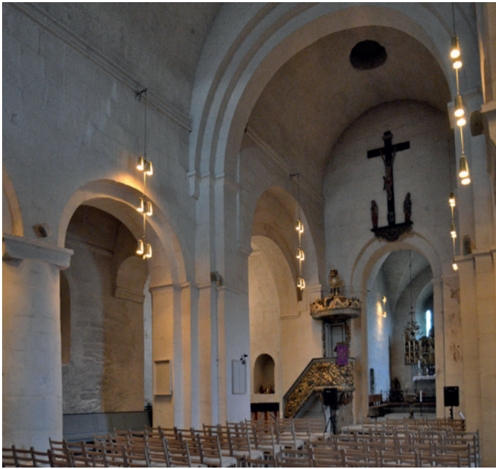
▲ Middelalderkirkene er bygget etter prinsippet om at vekten fra materialene holder konstruksjonen på plass. Ringsaker kirke.
