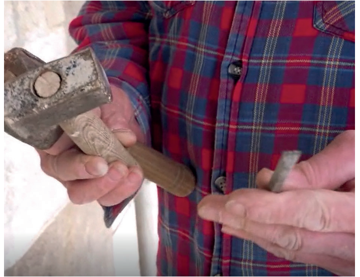
▲ Renhogging av fuger krever meisler og hammere i ulike størrelser. Foto: Lars Thomle
