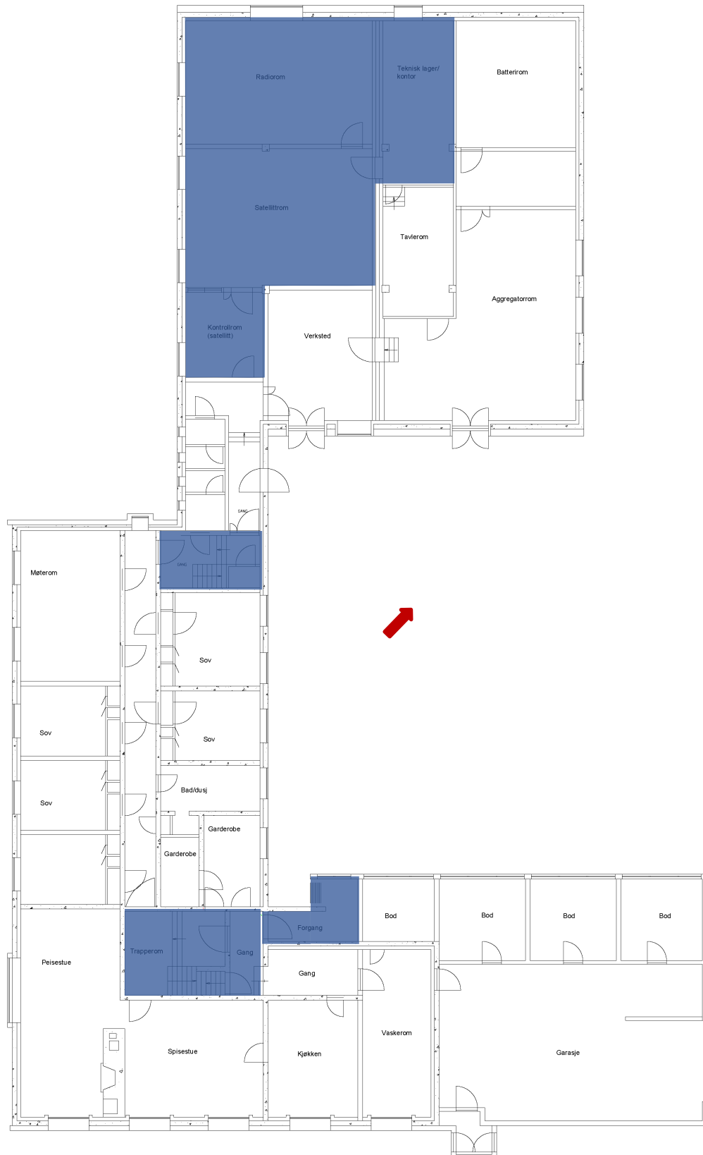
Figur 7: Plantegning Hovedstasjon, 1 etasje. Rom omfattet av interiørfredningen er markert med blått. Rød pil markerer nord.
