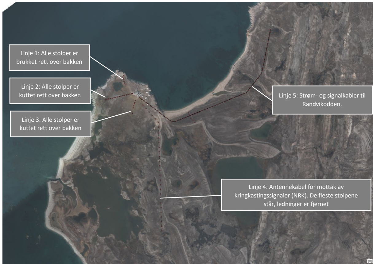
Figur 117: Lednings- og antennetraséer på Isfjord radio.
