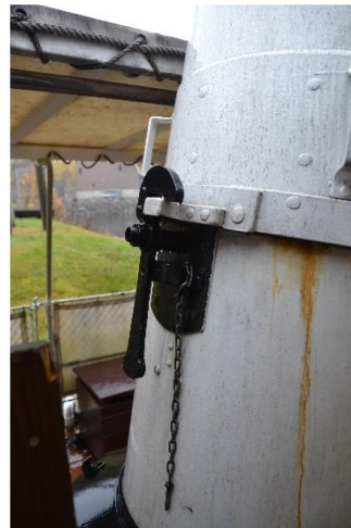
Låsing – øvre del av skorstein.
