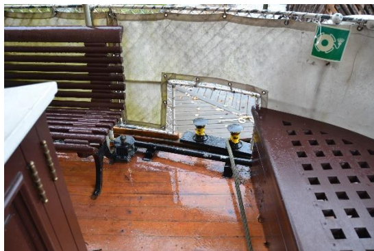
Puller akter – styrbord. Til venstre original benk. Kjettingstyring
