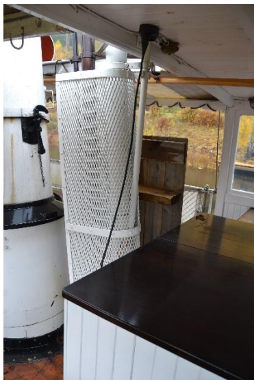
Beskyttelse, rist for rørsystem – fløyte.
