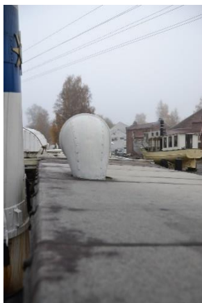
Luftelyr – topp – styrbord. Seilduk baldakintak.
