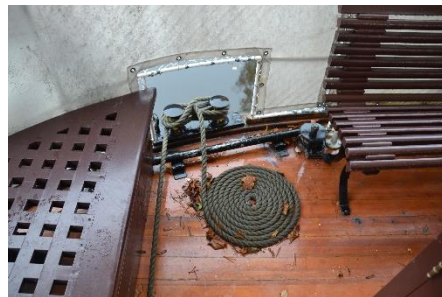
Aker puller – festeanordning til spring Kjettingsstyring, deksel rorflyndre.
