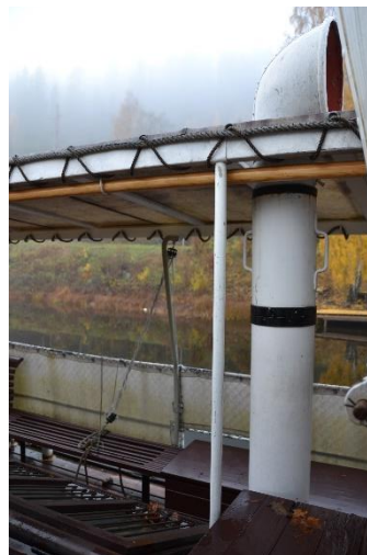
Tverrsnitt av babord luftelyr. Svanehalser produsert av HA, toppen er gjenbruk fra annet skip.
