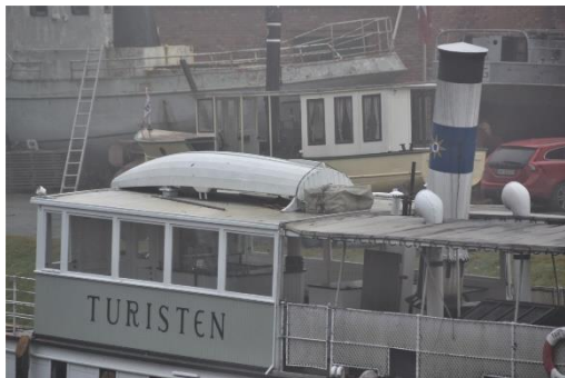
Tversnitt – skorsteinsgjennomføring fra promenadedekk til friluft. To stk. luftelyrer fra dekknivå under akter for skorstein. Toppene her er gjenbruk fra annet ukjent skip.
