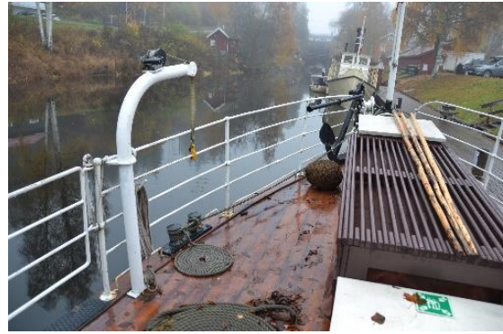
Davitt for mobbåt – babord puller forut. Rekke fra davitt til svinerygg er den opprinnelige.
