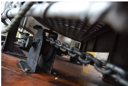
Kjettingsstyring – ruller. Produsert ved HA, Stathelle.
