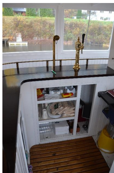
Oppbevaringsskap – Taletut, rør for kontakt med byssa. Innkjøpt på maritimt brukmarked i England.
