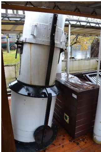
Nedre del av skorstein – krage og blylodd til senkning av øvre del av skorstein ved broer i vassdraget.
