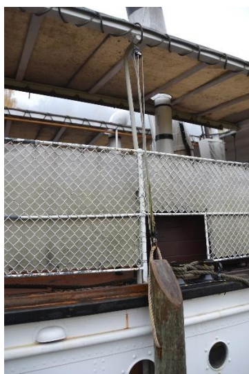
Festeanordninger – seilduk – baldakintak. Rekkesepter rekonstruert med utgangspunkt i bevart original – opprinnelig septer (nederste bilde, fra Haldenvassdragets Kanalmuseum på Ørje).
