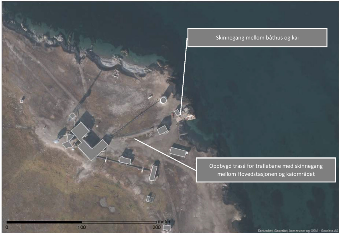
Figur 161: Oppbygd trasé for skinnegang mellom kaiområdet og Hovedstasjonen, samt ny skinnegang til Båthuset.
