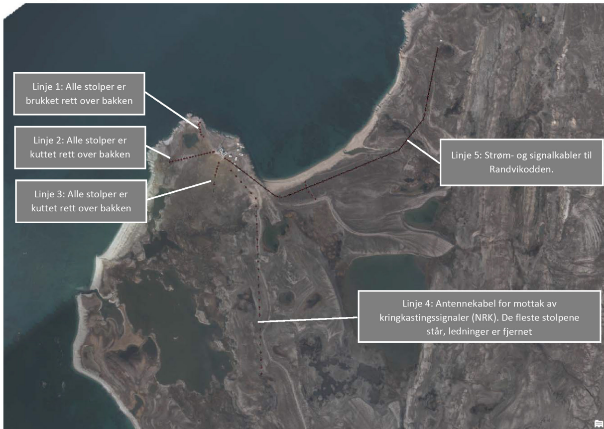
Figur 159: Lednings- og antennetraséer på Isfjord radio.
