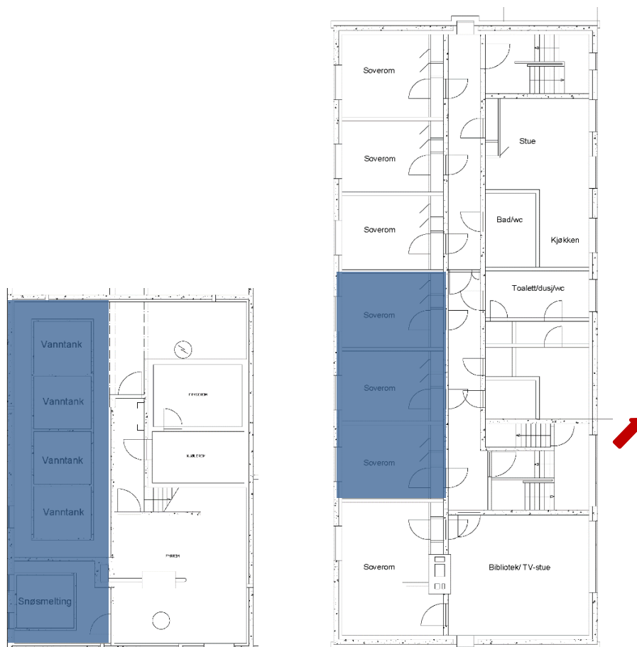
Figur 6: Plantegning Hovedstasjonen, boligdel. Til venstre: kjeller. Til høyre: 2. etasje. Rom omfattet av interiørfredningen er markert med blått. Rød pil markerer nord. Grunnlag for plantegning er brannplan for Hovedstasjonen (Store Norske). Utforming av tank i rom for snøsmelting har annen utforming i virkeligheten, se foto i dokumentasjonsvedlegg.
