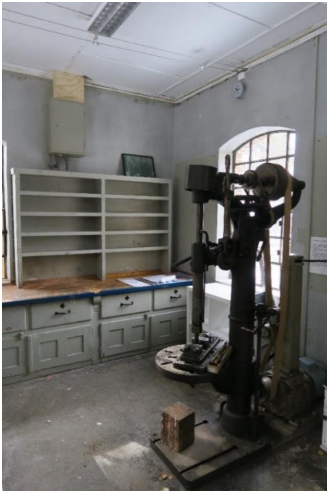
Tv. plassbygd benk med skap og skuffer og med søylebormaskin i forgrunnen ved vestre vegg. Th. detalj av søylebormaskinen.
