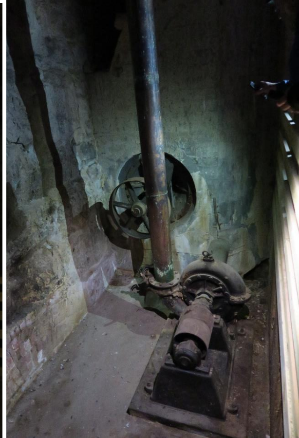
Tv. en del av akslingen fra turbinen til slipemaskinen på nivå 2. Bak gjerdet i bakkant er det et maskineri, sannsynligvis knyttet opp mot reimverket og hovedturbinen. Se bildet til høyre. Th. sannsynligvis en del av reimverksystemet.
