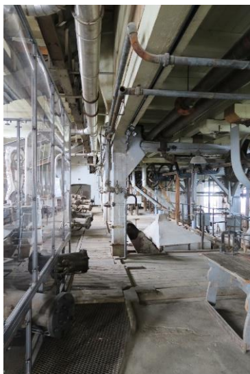
Tv. sorteringen øst for rekka med horisontale slipemaskiner. Th. Her ses grovsollet. Dette ble benyttet for å sortere ut de største bitene i tremassen. Den var en del av produksjonen fra tidlig av. Eksakt tidspunkt når akkurat denne ble tatt i bruk er usikkert, men en form for sulling av grovt materiale var en del av maskineriet fra starten. Sett mot maskinhallen i øst.
