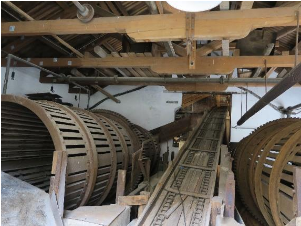
Trommel mot øst og vest og med kubbtransportøren i midten. Denne frakter kubbene inn i og gjennom Kapphuset og videre inn i Sliperisalen.
