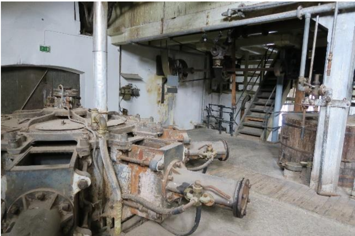
Slipemaskin i forgrunnen, og dør inn til kapphuset. På veggen er det blant annet et reimverk.
