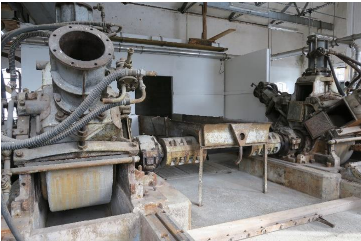
Tv. de to vertikale treslipemaskinene med en renne fra kubbsiloen i midten. Kubbsiloen er et basseng. Kubbene kom til kubbsiloen med vann ved hjelp av kubbtransportøren. Fra siloen ble kubbene fløtet opp på karet mellom maskinene.
