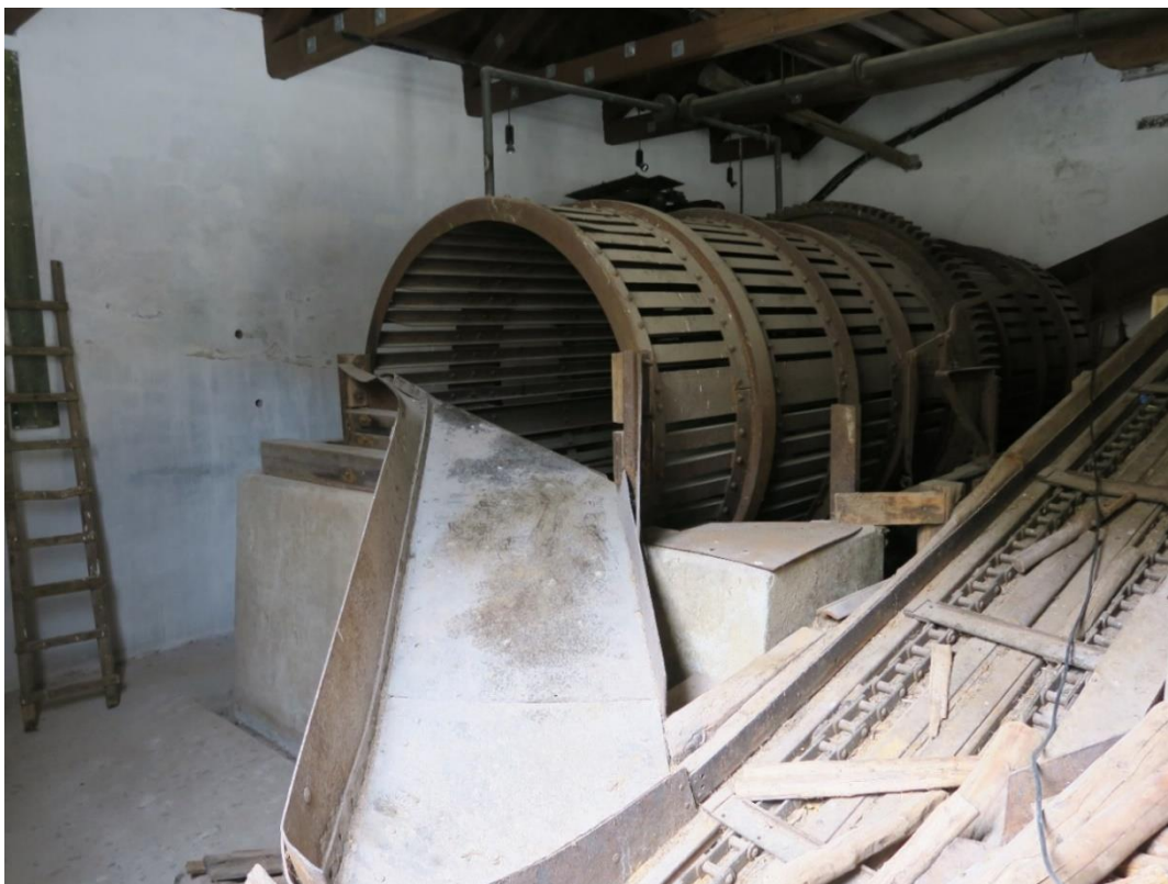
Trommel mot østre vegg med renne mot kubtransportøren.
