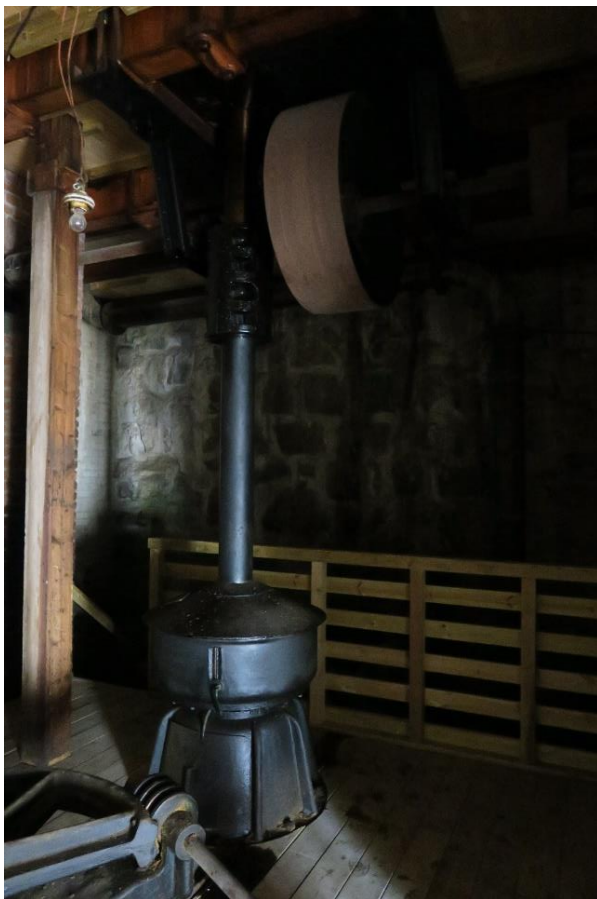
Tv. en del av akslingen fra turbinen til slipemaskinen på nivå 2. Bak gjerdet i bakkant er det et maskineri, sannsynligvis knyttet opp mot reimverket og hovedturbinen. Se bildet til høyre. Th. sannsynligvis en del av reimverksystemet.
