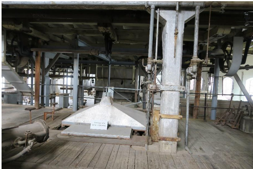
Tv. sorteringen øst for rekka med horisontale slipemaskiner. Th. Her ses grovsollet. Dette ble benyttet for å sortere ut de største bitene i tremassen. Den var en del av produksjonen fra tidlig av. Eksakt tidspunkt når akkurat denne ble tatt i bruk er usikkert, men en form for sulling av grovt materiale var en del av maskineriet fra starten. Sett mot maskinhallen i øst.
