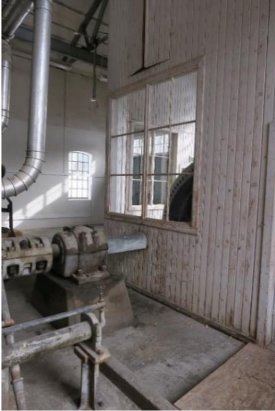
Th. koblingen mellom treslipemaskinene og generatoren som er plassert på andre siden av veggen mot sør.
