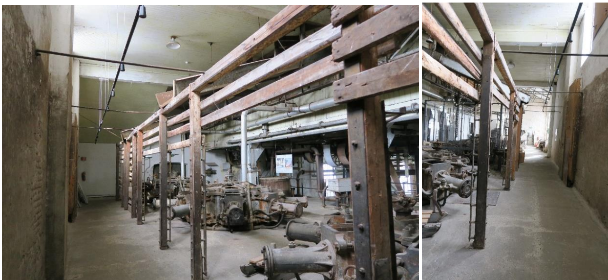
Tv. Kubbsiloen mellom vestre yttervegg og gjerdet/stengselet i tre, sett fra sør mot nord. Rennene i kubbtransportøren kunne skyves frem og tilbake, men sannsynligvis var de plassert på omtrent samme sted det meste av tiden, for langs den vestlige vegg er det partier med beskyttelse/polstring som trolig er satt opp for å ta imot kubbene som stadig raste ned i siloen med stor fart. Th. til høyre i bildet ses polstringen på vestlige yttervegg.
