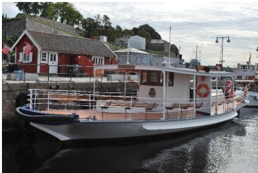
Babord og styrbord side. Legg merke til den «falske» stevnen som kom som en ombygging i 1952. Da gikk «balja» fra å være pendelferge med fremdrift i begge ender til kun propell og ror i én ende.
