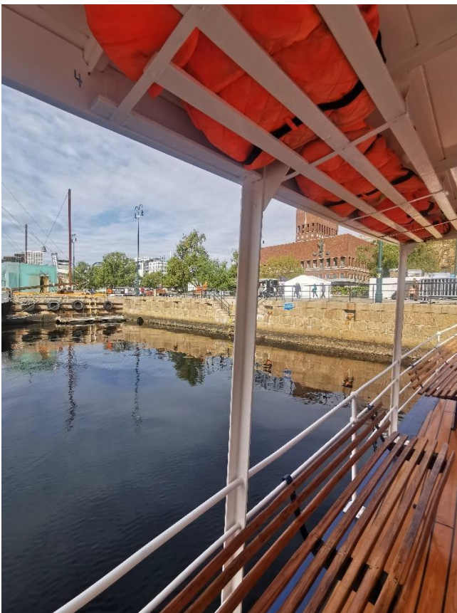
Stendere takoverbygg – livebelte hyller og benkerader – BB-side.
