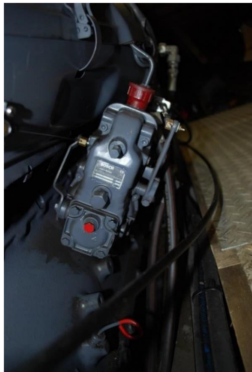
Dieselpumpa, styrer mengde diesel som en forgasser.
