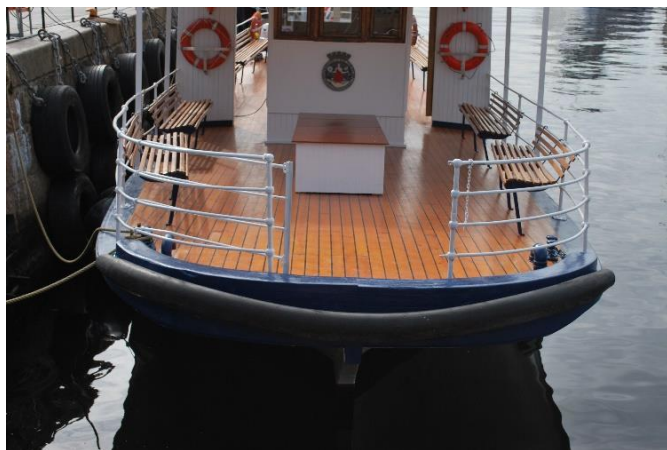
Rekkeledning med karakteristisk åpning for pendelferge i front.
