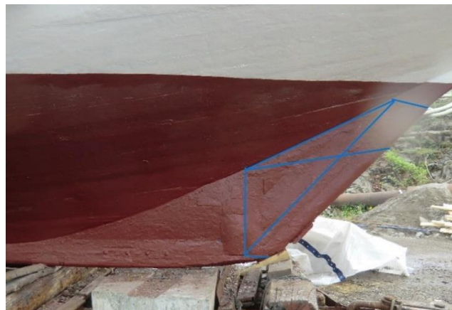
Den falske forstevnen er fremdeles godt synlig på båten. Foto: Sondre Norberg, Promhavn Slipp AS
