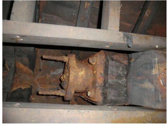
Pakkboksen i forskipet (forut i fartøyet) fra tidligere fremdrift som pendelferge med propell i begge ender. Foto: Promhavn Slipp AS
