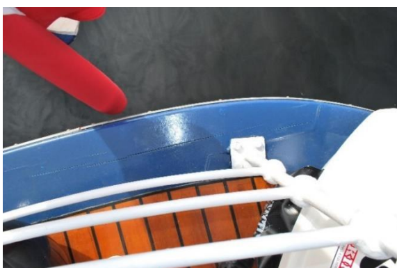
Feste til septer/rekke-støtte på fenderlist.
