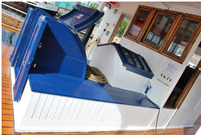
Dekkshus er endret fra leveransen i 1923, dette ble gjort i 1970, med ny luftavkjølt motor som krevde ny kjøleluftkanal/eksosuttak.
