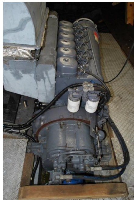
Deutz 6FL 912, diesel 4-takt, luftkjølt, 75 bremsehesterkrefter.
