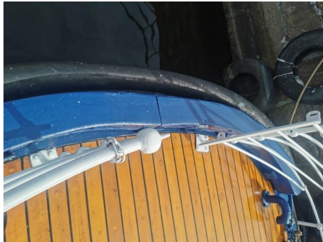
Fenderlist og fenderbjelke i baugen.
