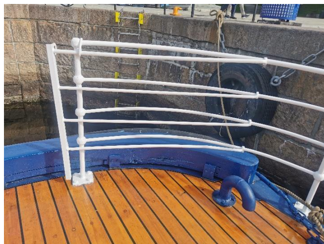
Eksempel på original rekkesepter og låseanordning for utgang forut. Svane Hals og fenderbjelke.
