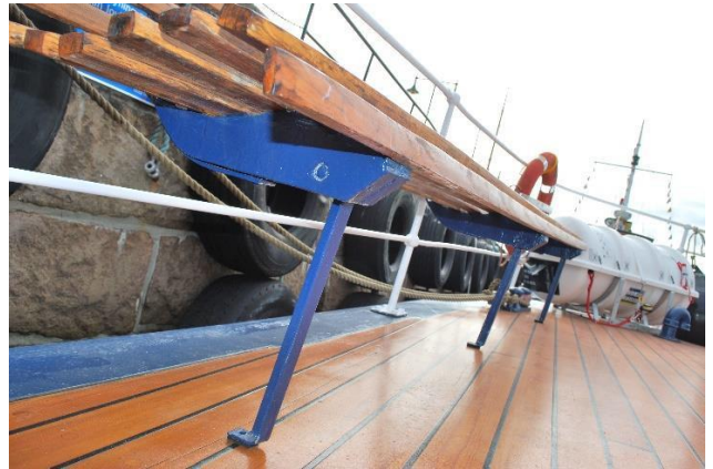
Festeanordning – benkerad, BB-side.
