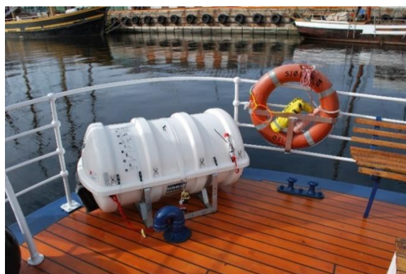
Benk, feste til redningsbøye, puller og svane-hals til lufting, BB-side.
