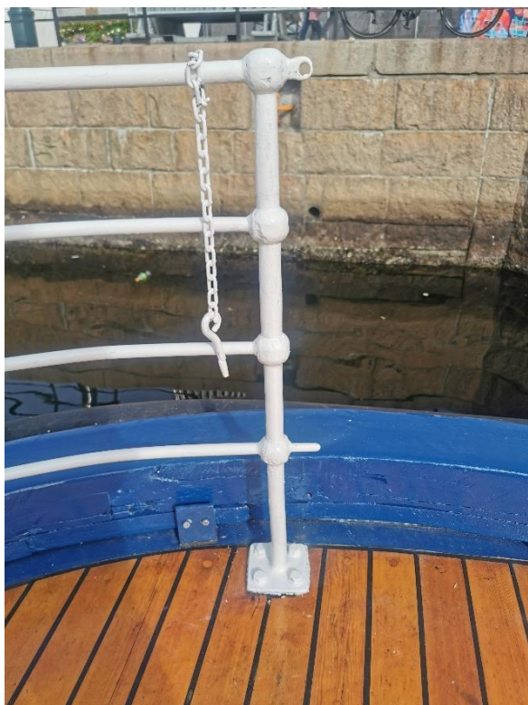
Eksempel på original rekkesepter og låseanordning for utgang forut.
