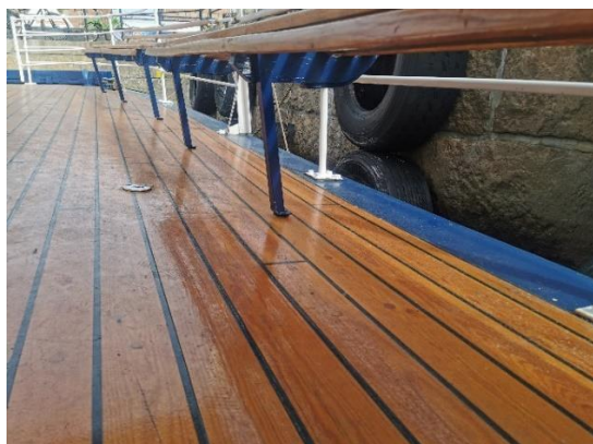
Feste mellom benkerad og dekk, SB-side.
