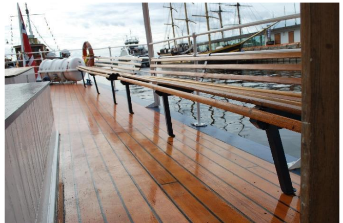
Festeanordning – benkerad BB-side.
