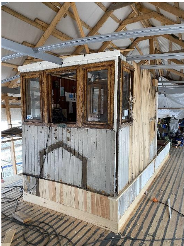
Styrhusfronten med tydelig malingsriss av det gamle skylightet forut under kappen, der styrhuset er flyttet fram etter motorbyttet i 1970. Vi ser også tydelig at en del nytt panel er felt inn i styrhusveggen der styrhuset er forlenget.
