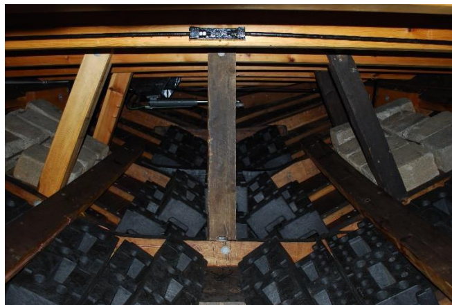
Akter – styringsmekanismen og blyballast.
