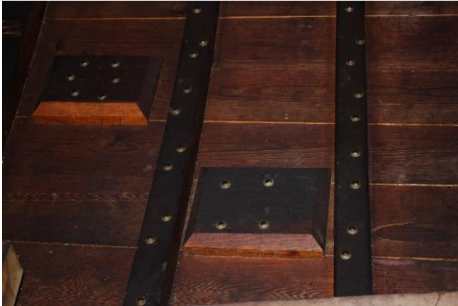
Skrog og band innvendig, lasker og skjøtemetode for bordganger, SB-side.
