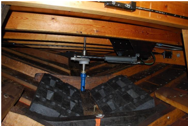
Styringsmekanismen til roret.
