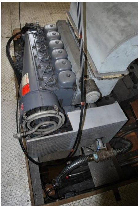
Deutz 6FL 912, diesel 4-takt, luftkjølt, 75 bremsehesterkrefter.
