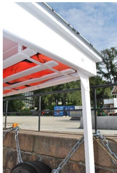
Takoverbygg, ståprofil og stender – SB-side.
