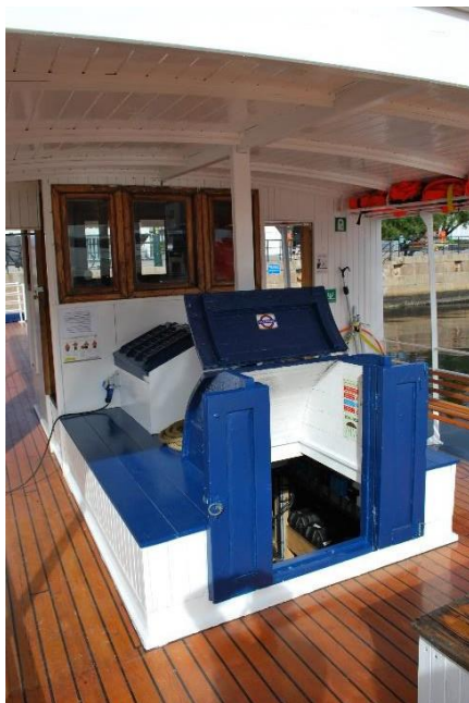
Nedgangskappe til maskinrom.
