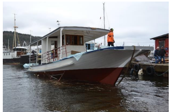
Babord og styrbord side. Legg merke til den «falske» stevnen som kom som en ombygging i 1952. Da gikk «balja» fra å være pendelferge med fremdrift i begge ender til kun propell og ror i én ende.
