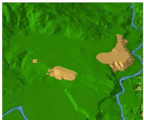
*Figur 1: 1) Datamodell av Stødleterrassen basert på eldre kart slik den var før uttak av sand byrja.
