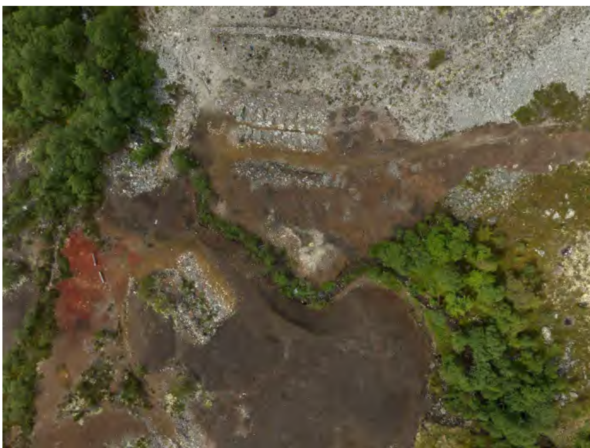
Figur 7. Oversiktsbilde av smeltehytteplassen med smeltehyttetuft, vendrøsteovner, kaldrøsteplass og slagghauger. Foto: Trond Isaksen/Riksantikvaren.
