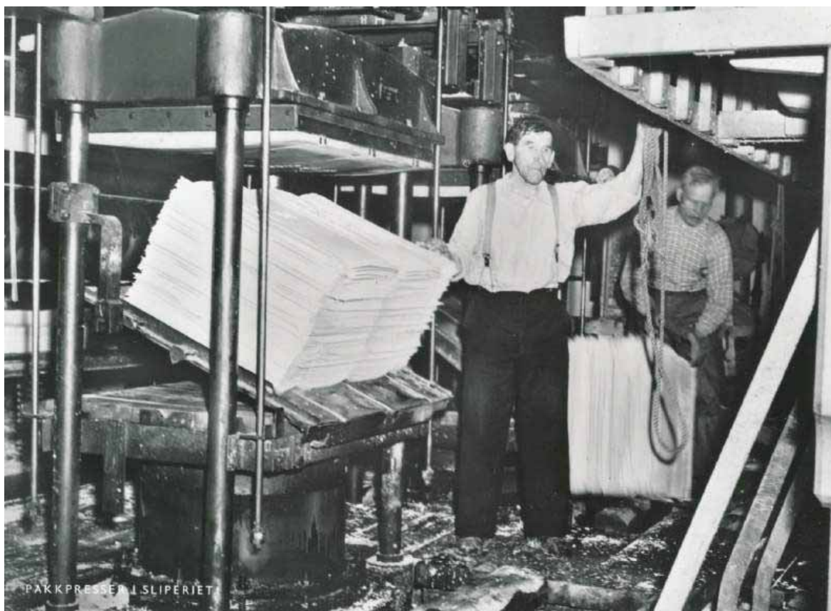
Tremassearkene er lagt i pakkpressa og presses der til en tremasseball. Fotografiet er fra tresliperiet A/S Helge-Rein-Bybrug som ligger ved Byafossen utenfor Steinkjer i Trøndelag. Bildet er tatt i 1956. Foto: Kistefos-museet, KIS.F000739
