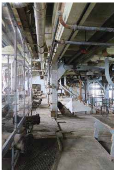
Tv. sorteringen øst for rekka med horisontale slipemaskiner. Th. Her ses grovsollet. Dette ble benyttet for å sortere ut de største bitene i tremassen. Den var en del av produksjonen fra tidlig av. Eksakt tidspunkt når akkurat denne ble tatt i bruk er usikkert, men en form for salling av grovt materiale var en del av maskineriet fra starten. Sett mot maskinhallen i øst.
