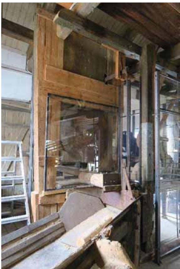
Tv. nærmest til høyre kommer tømmerstokkene inn på rullebommen gjennom østre vegg og kappes. Kappen går videre til transportrenna som fører til Renseriet. Th. kappsag og renne til høyre i bildet ved østre vegg.
