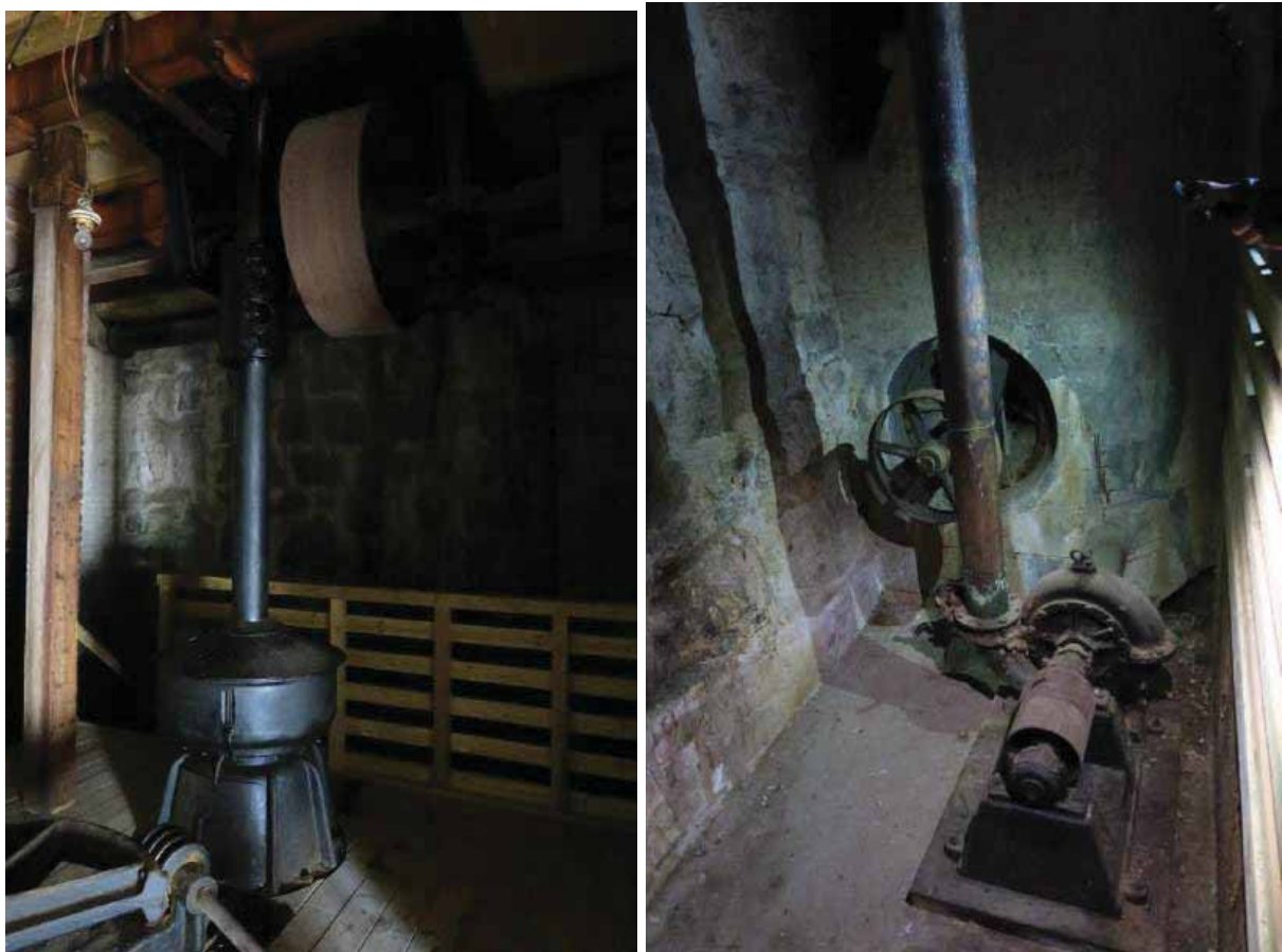
Tv. en del av akslingen fra turbinen til slipemaskinen på nivå 2. Bak gjerdet i bakkant er det et maskineri, sannsynligvis knyttet opp mot reimverket og hovedturbinen. Se bildet til høyre. Th. sannsynligvis en del av reimverksystemet.
