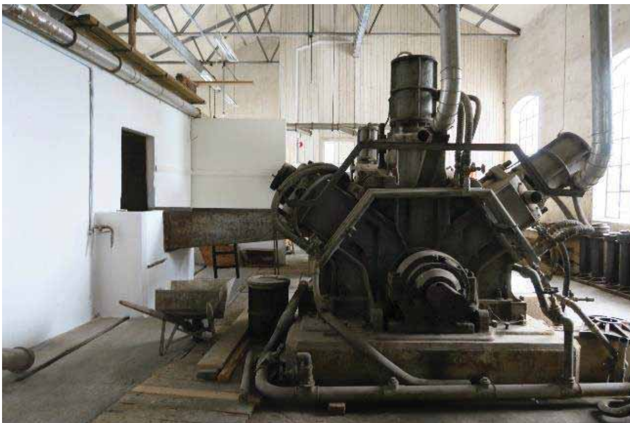
De to vertikale treslipemaskinene, som kom til Kistefos i 1946, med en transportrenne i midten. Denne er koblet til den hvitmalte kubbsiloen til venstre i bildet.
