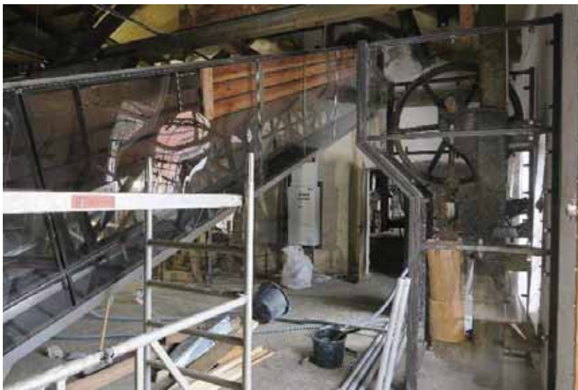
Tv. kubbtransportøren for kubber til Sliperiet. Th. detalj av kubbtransportøren og kubbkløyveren, også den beskyttet med plexiglass, til høyre i bildet. I bakgrunnen er det en dobbel dør i metall som fører til Sliperisalen.
