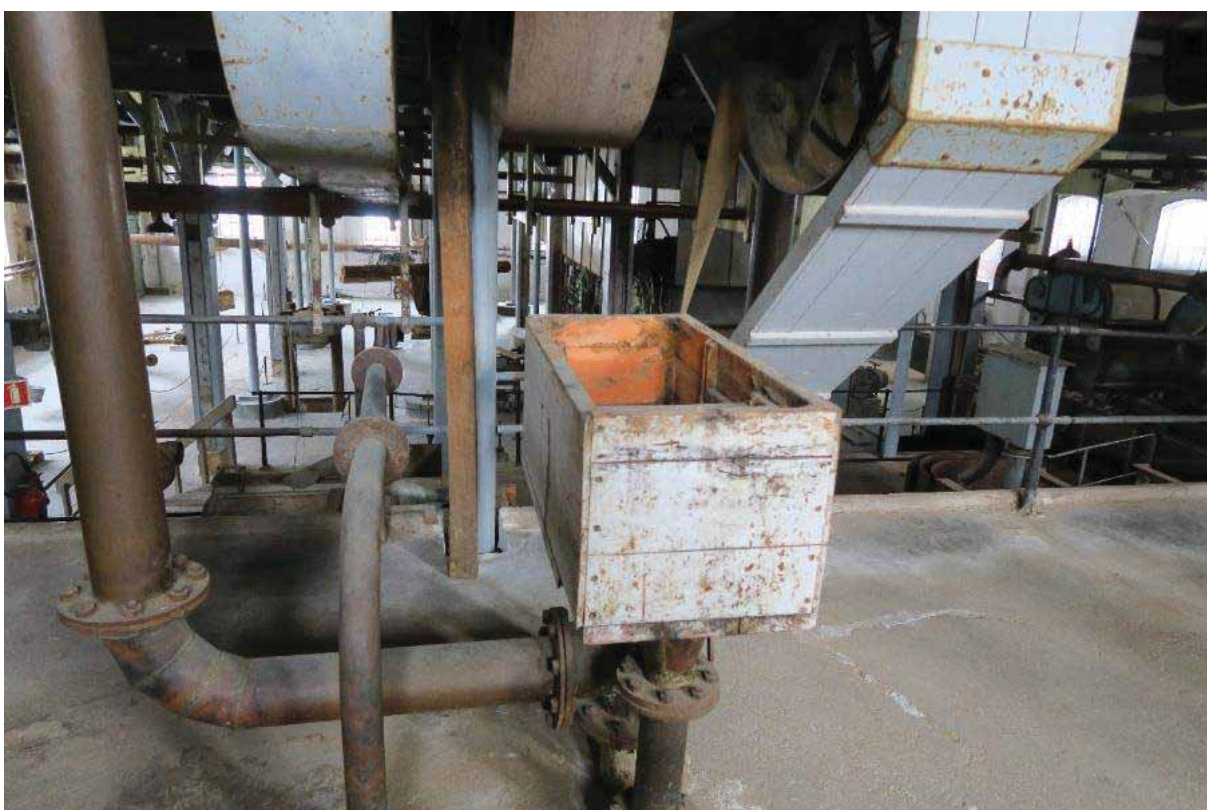
Grove biter etter sliping ble plukket ut av tremassen og gikk videre til mølla for ettermaling. Her er påfyllingsboksen til mølla med røropplegg videre til mølla.
