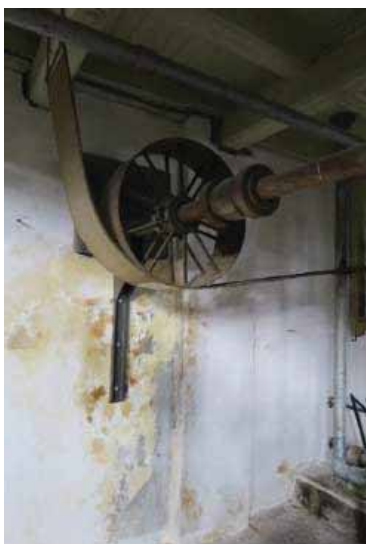
Tv. detalj av reimverk på vegg mot nord. Th. en av slipemaskinene er «satt i drift» og kan settes i gang som en demonstrasjon for publikum på hvordan den fungerer, men den har bare en brøkdel av farta den en gang hadde. Den er ikke koblet opp mot turbinen i kjelleren.
