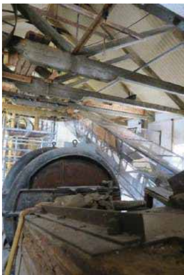
Tv. kubbtransportøren for kubber til Sliperiet. Th. detalj av kubbtransportøren og kubbkløyveren, også den beskyttet med plexiglass, til høyre i bildet. I bakgrunnen er det en dobbel dør i metall som fører til Sliperisalen.
