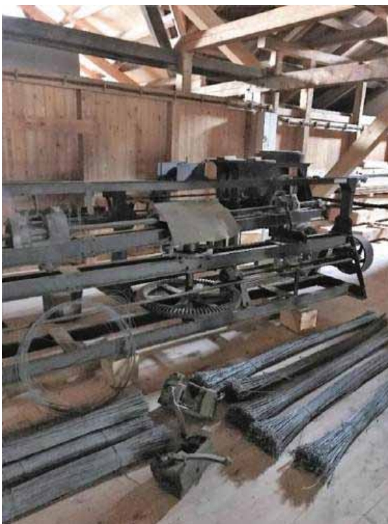
Tv. loftet sett mot vestre vegg. Th. denne maskinen ble brukt til å pakke wire rundt tremasseballene før de skulle sendes med balleheisen. Den sto på Sliperiloftet slik den gjør i dag. Wirepakking av tremasseballene ble tatt i bruk ca. 1910-1920. Tremasseballene ble tidligere pakket i striesekker, en periode etter det med et rammeverk av staver.
