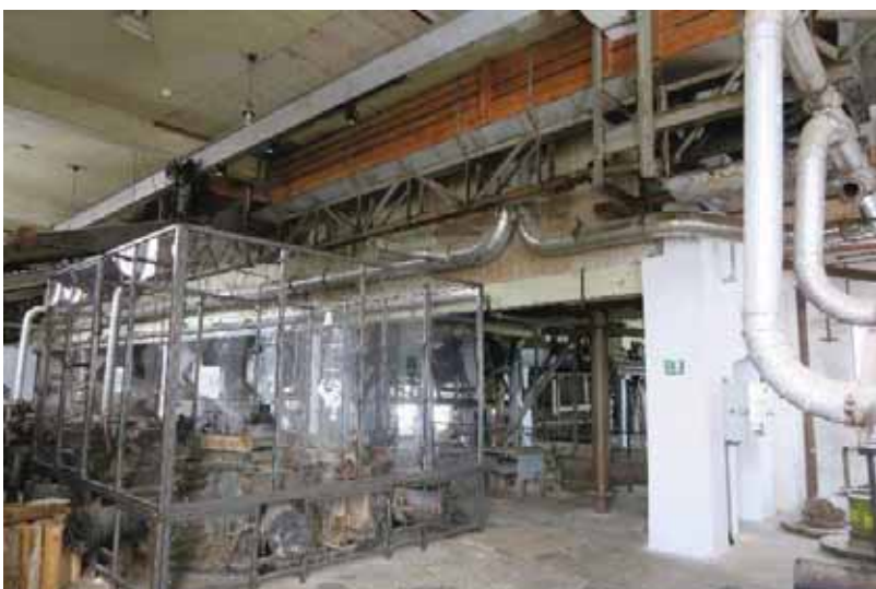
Tv. detalj av reimverk på vegg mot nord. Th. en av slipemaskinene er «satt i drift» og kan settes i gang som en demonstrasjon for publikum på hvordan den fungerer, men den har bare en brøkdel av farta den en gang hadde. Den er ikke koblet opp mot turbinen i kjelleren.
