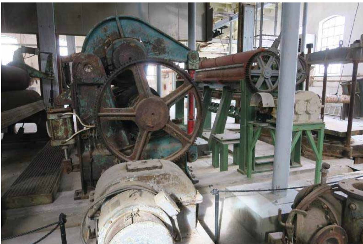
Dette er pressene og saksen i oppfangingsmaskinen. Arkene som ble skåret på oppfangingsmaskinen gikk i pakkpressene som ses helt til høyre i bildet. Pressene er originale. Denne delen av oppfangingsmaskinen erstattet de såkalte pappmaskinene. Det fantes elleve stykker av dem og de var manuelle. Sett mot nordre yttervegg.
