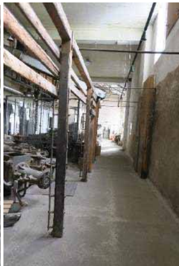
Tv. Kubbsiloen mellom vestre yttervegg og gjerdet/stengselet i tre, sett fra sør mot nord. Rennene i kubbtransportøren kunne skyves frem og tilbake, men sannsynligvis var de plassert på omtrent samme sted det meste av tiden, for langs den vestlige veggen er det partier med beskyttelse/polstring som trolig er satt opp for å ta imot kubbene som stadig raste ned i siloen med stor fart. Th. til høyre i bildet ses polstringen på vestlige yttervegg.
