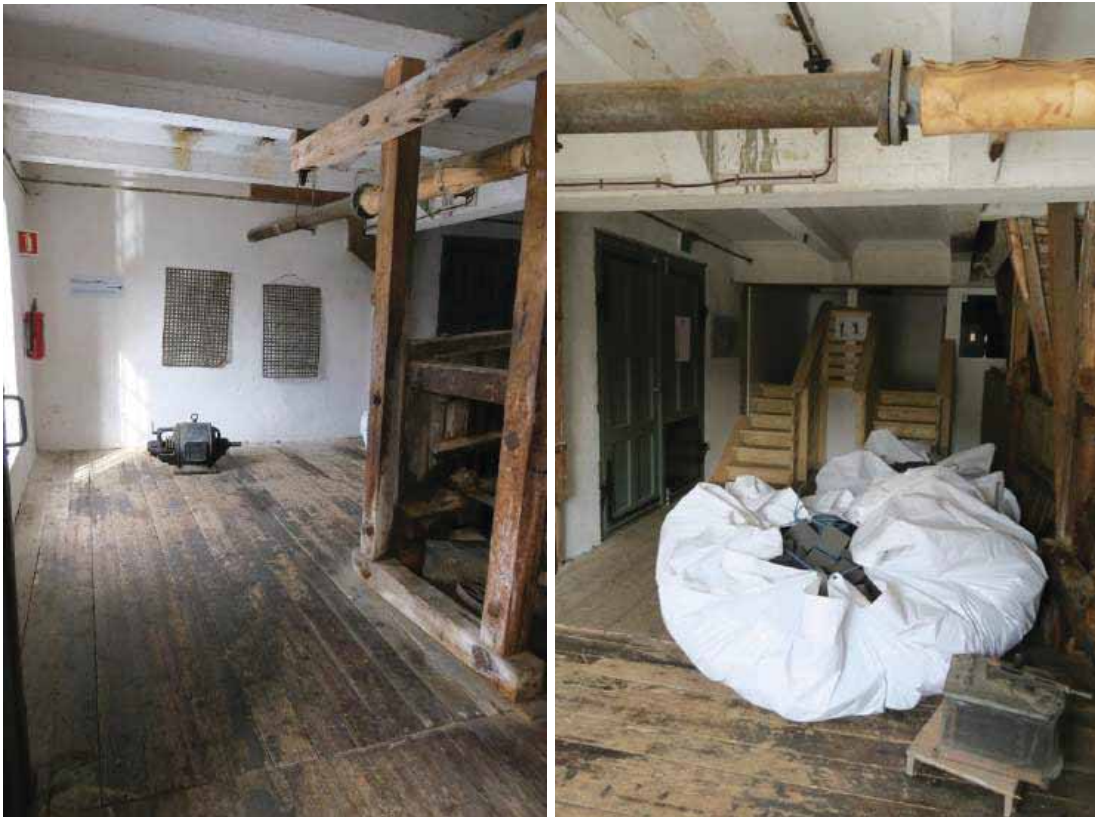
Tv. det nordlige rommet i mellomrommet, med transportøren for sagflis til høyre i bildet. Th. bak i rommet ses trapper til hoppebingene for besøkende, en ny museumstilpasning. Bingene er gamle sjakter for flisavfall fra kapphuset. Flisen ble sendt videre til fyrhuset på en transportør. Denne ses til venstre i bildet. Hvit pose i front er innhold til hoppebingen.
