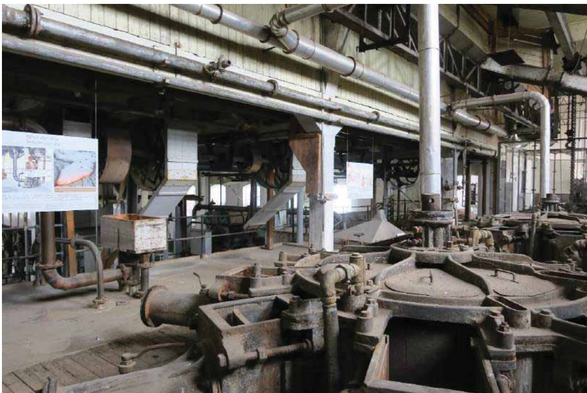
Sorteringen sett fra sliperisalen med slipemaskin i forgrunnen. Til venstre i sorteringen ses den hvite kassa som er påfyllingen til mølla, og til høyre metallokket som er grovsollet.
