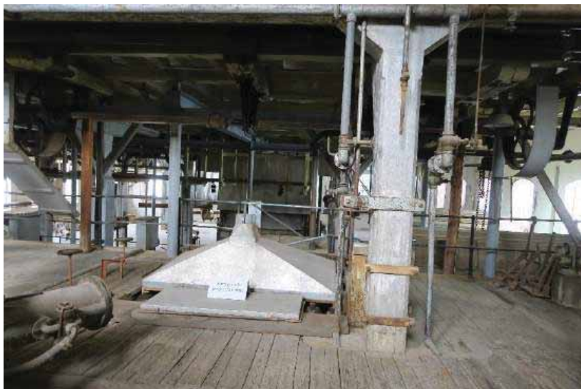
Tv. sorteringen øst for rekka med horisontale slipemaskiner. Th. Her ses grovsollet. Dette ble benyttet for å sortere ut de største bitene i tremassen. Den var en del av produksjonen fra tidlig av. Eksakt tidspunkt når akkurat denne ble tatt i bruk er usikkert, men en form for salling av grovt materiale var en del av maskineriet fra starten. Sett mot maskinhallen i øst.
