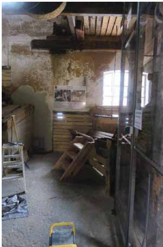
Tv. nærmest til høyre kommer tømmerstokkene inn på rullebommen gjennom østre vegg og kappes. Kappen går videre til transportrenna som fører til Renseriet. Th. kappsag og renne til høyre i bildet ved østre vegg.
