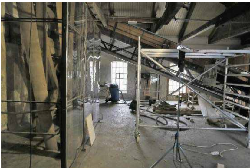
Tv. lengst til venstre ved søndre vegg ses reimverket for drift av maskineriet. Det er beskyttet med plexiglass. Reimverket går tre-fire etasjer ned og er koblet til en driftsturbin. I senter under kubbtransportøren og i bakgrunnen ses kubbkløyveren. Th. detalj av kubbkløyveren ved vestre vegg, også den beskyttet med plexiglass..
