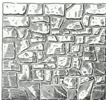
Ref. 23.11 Bruddsteinsmur, gotisk murverk
