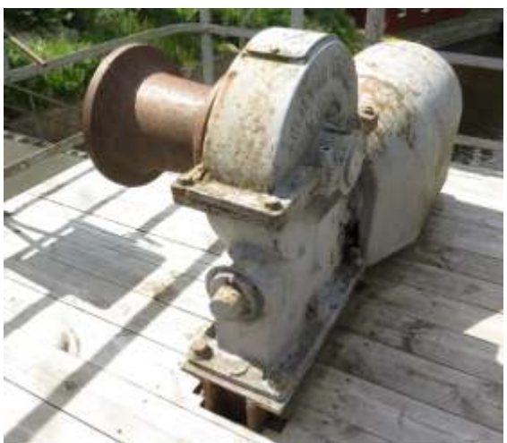
Slusekamre ved slusekiosk 1, 3 og 5 har vinsjer for å kunne trekke tømmeret inn i slusene.
