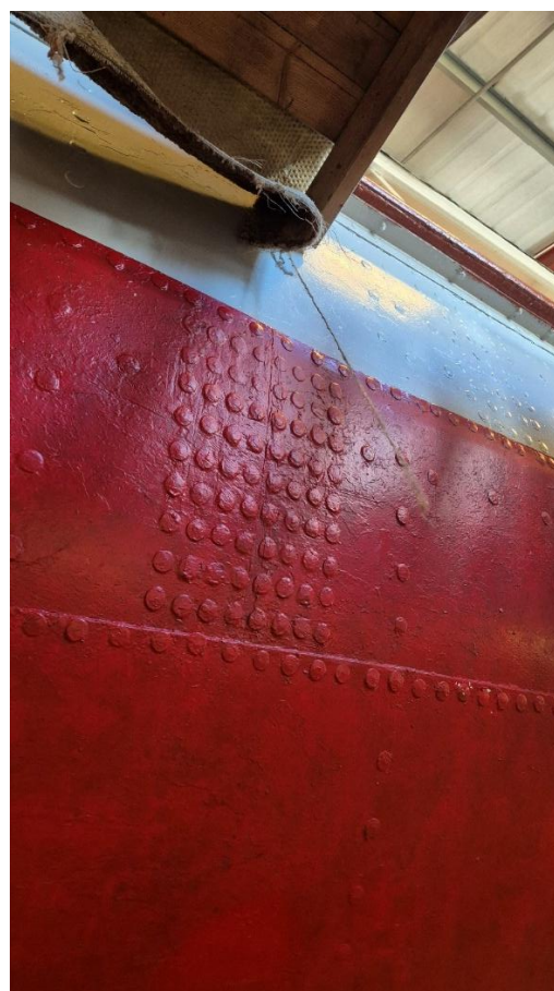
Babord side, under vannlinje. Her syner en også skjøten der fartøyet var delt under transport til Byglandsfjorden. Biletet tatt 6/5-2026. Foto: Kjartan Nordby, Agder fylkeskommune.
