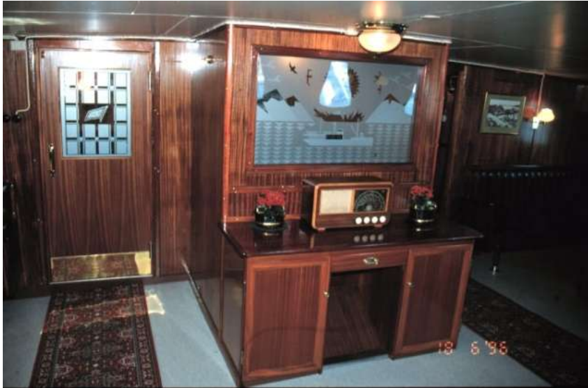
Figur 41 Nye svingdører til salong 301. Det var nytt lyst, vinylbelegg på dørken. Der det nå stod et bord mellom dørene var det opprinnelig en sofa/sittebenk. Foto: BDF, Arild Fredriksen, 1998
