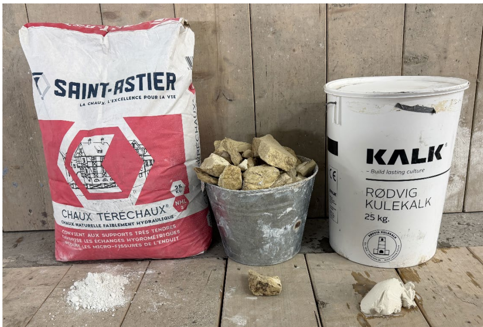
Dei vanlegaste kalkprodukta: NHL i sekk, tradisjonsbrent stykkkalk og våtleska kulekalk. Foto: Martin Mannhart.
