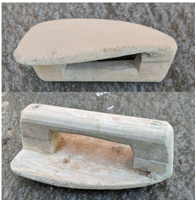
Små pussebrett forma som strykejern (snutebrett) eignar seg godt til skuring av fuger og puss som skal følge karakteren til murverket. Foto: Per Storemyr, Fabrica.
