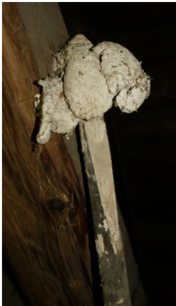
Kvitkalking må haldast ved like slik det har vore gjort gjennom hundreåra. Kalkfille og kalktønne frå kyrkjeloft. Foto: Morten Stige, Fabrica.
