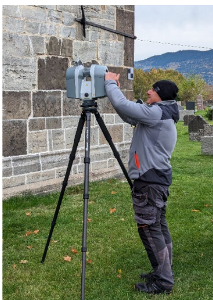
Murverket i Nikolaikirkeja på Gran blir dokumentert med laserskanning og fotogrammetri. Foto: Morten Stige, Fabrica.
