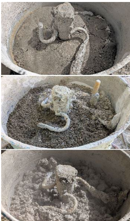
Mørtellesking i tvangsblandar. Øvst: Sand og brentkalk er lagt lagvis, med sand på toppen, og det er tilsett vatn tilsvarande omlag 1,5-2 gonger volumet på brentkalken. Leskinga går føre seg ved høg temperatur i dampen som blir utvikla. I midten: Når leskinga er ferdig og temperaturen går ned, blir det først blanda tørt. Nedst: Blandaren går ved tilsetjing av meir vatn til ønskt konsistens. Foto: Per Storemyr, Fabrica.
